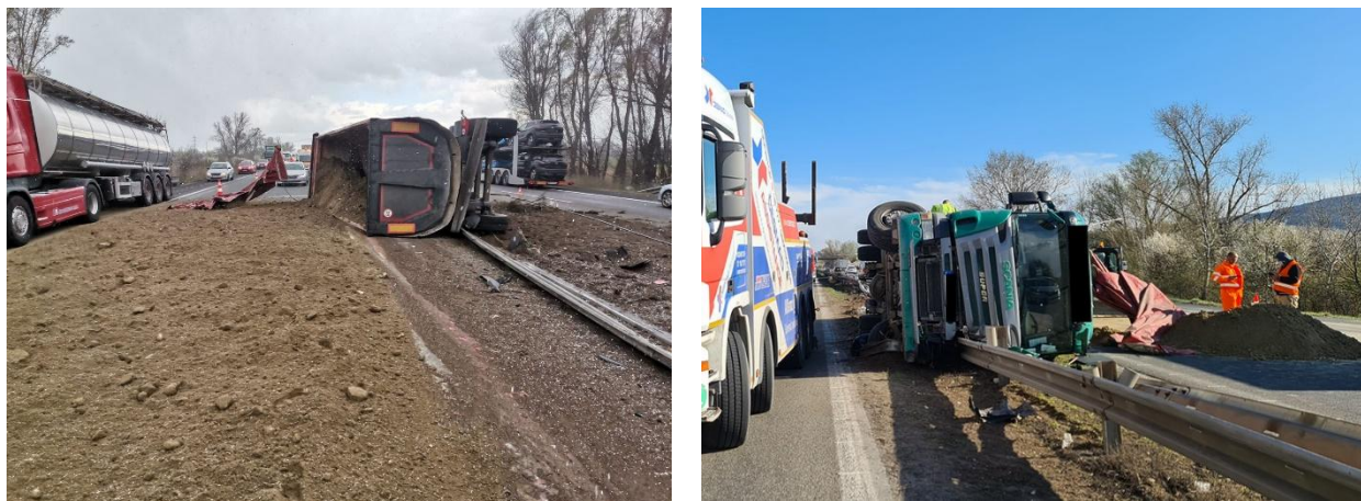
Obr. 7 Dopravná nehoda na diaľnici D2 – prekonanie zvodidiel v SDP, nákladné vozidlo v protismere [8]
