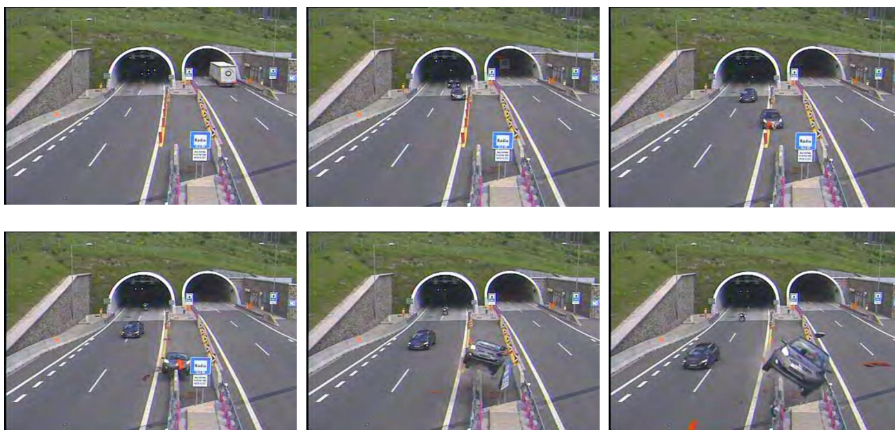
Obr. 4 Kolízia motorového vozidla s betónovým zvodidlom [8]
