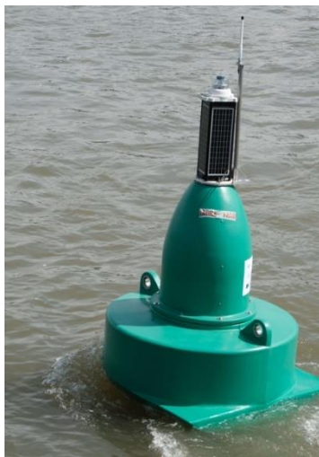
Obr. 2. Fyzický AIS AtoN a jeho súčasti – LED svetidlo, napájanie 12V/60Ah batéria, hmotnosť 40 kg. [7]
