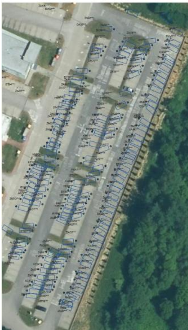
Obr. 6. Zobrazenie vozidiel nameraných počas prieskumu statickej dopravy pomocou mobilného telefónu – detailnejší pohľad
