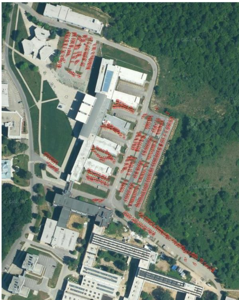
Obr. 4. Zobrazenie vozidiel nameraných počas prieskumu statickej dopravy pomocou fotoaparátu s GPS modulom – pohľad na všetky parkoviská
