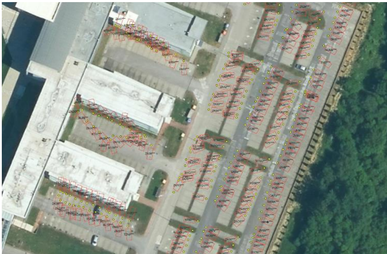
Obr. 5. Zobrazenie vozidiel nameraných počas prieskumu statickej dopravy pomocou fotoaparátu s GPS modulom – detailnejší pohľad
