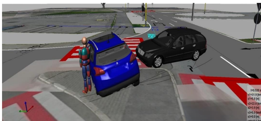
Obr. 8. Vzájomná poloha vozidiel a chodkyne v okamihu nárazu vozidla Peugeot 2008 do chodkyne
