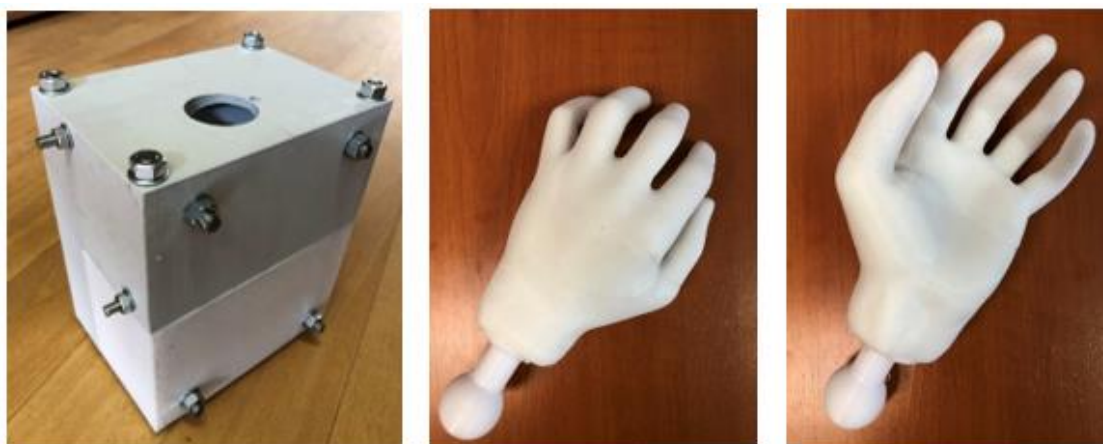
Obr. 7. Zľava doprava: Forma vcelku a výsledný odlieatok modelu ruky pomocou navrhnutej formy na odlievanie
