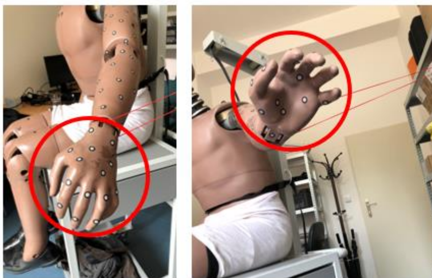
Obr. 1. Príprava časti ruky figuríny na skenovanie a rozmiestnenie referenčných bodov
