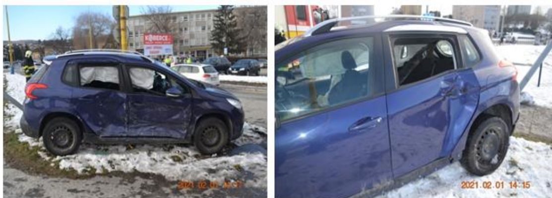
Obr. 2. Vozidlo Peugeot 2008 - celkový pohľad na poškodenie pravej časti vozidla (vľavo), ľavých zadných dverí a vrchnej časti ľavej bočnice vozidla (vpravo)
