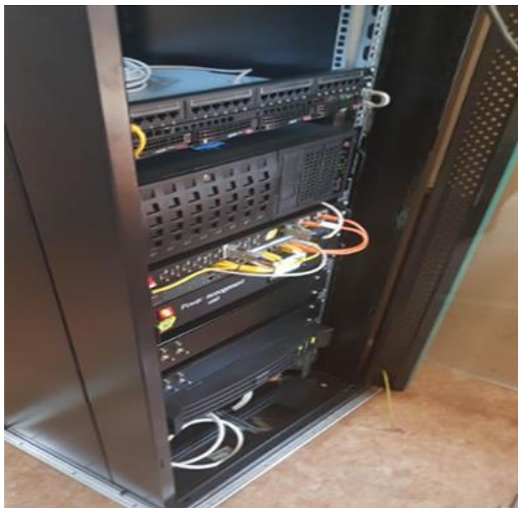
Obr. 2 Technológia zberu dát umiestnená vo vnútri vozidla
