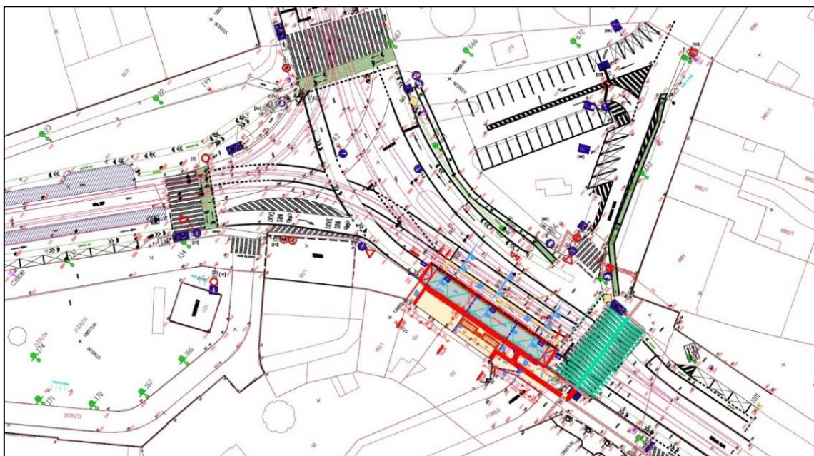
Obr. 10 Zameranie električkovej zastávky pred budovou Manderla
