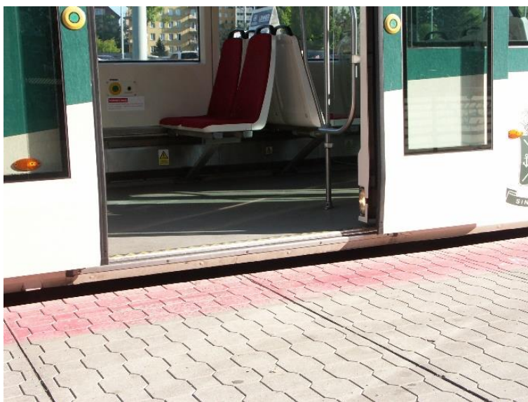
Obr. 2. Ideální stav u nového tramvajového provozu, kdy je nástupní hrana stejně vysoko, jako práh dveří vozidla (Francie, Le Mans, výška nástupní hrany 320 mm).
