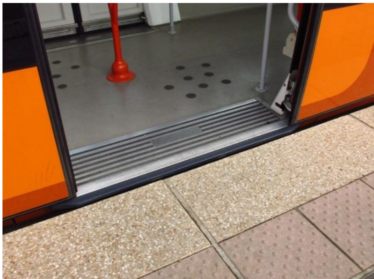
Obr. 2. Ideální stav u nového tramvajového provozu, kdy je nástupní hrana stejně vysoko, jako práh dveří vozidla (Francie, Le Mans, výška nástupní hrany 320 mm).
