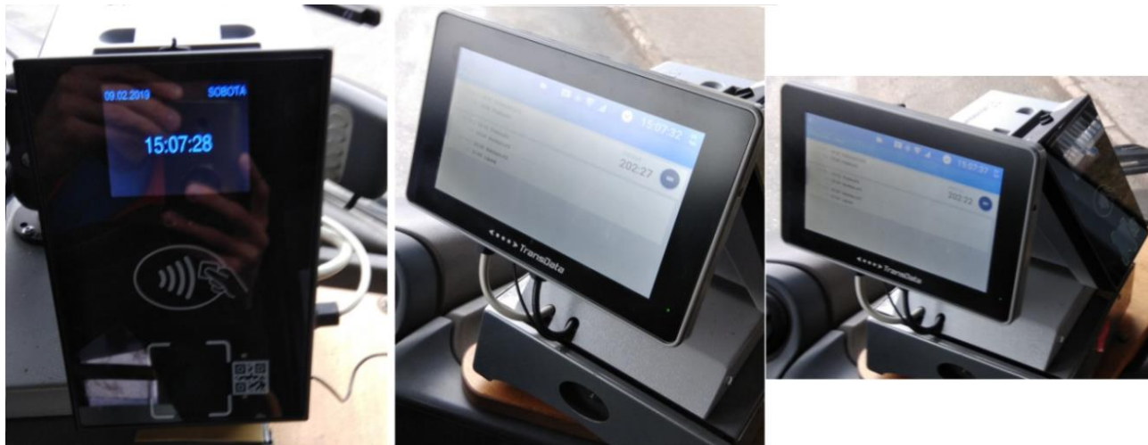
Obr. 10 Palubný počítač, resp. strojček v autobuse SAD Prešov slúžiaci k odbaveniu cestujúcich (čítačka BČK, čítačka bankomatových kariet a čítačky 2D kódu)
