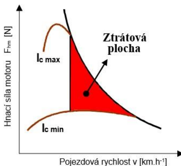
Obr. 2. Znázornění ztrátové plochy – nevyužitelná část výkonu motoru mezi dvěma převody v charakteristice F_{hm}-v
