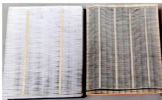
Obr. 2 Filtre vzduchu vozidla VW Golf 6
