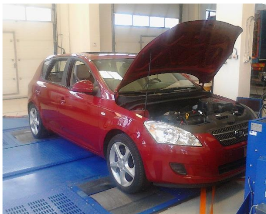
Obr. 1 Valcová skúšobňa MAHA MSR 1050 a jedno z meraných vozidiel Kia Ceed
