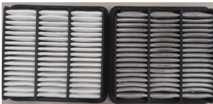
Obrázok 4 Filtre vzduchu použité vo vozidle Kia Ceed 1.6 CVVT
