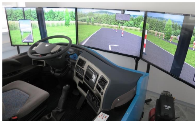
Obr. 4. Fotografia trenažéra SNA – 211 REN s pohľadom na LCD obrazovky
